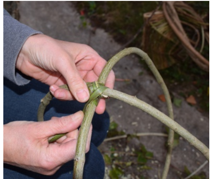
Assemblage de l'anse et de la côte principale en cornouiller sanguin avec un "oeil" en ronce. L'oeil permet ensuite de coincer les côtes intermédiaires qui permettront le tressage. Il sert d'élément de décoration.
